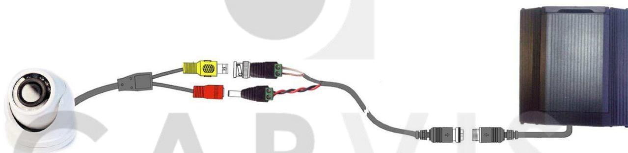
Соединение камер с комбинированным кабелем совершается при помощи коннекторов (штекер питания и BNC), входящих в комплект. Питание на камеру подается по красному (12V) и черному (GND) проводу по штекеру питания. Видеоизображение передается по коаксиальному кабелю и соединяется с камерой BNC коннектором.
